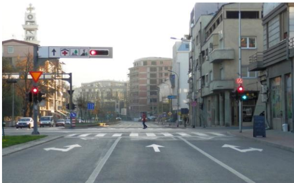
Стрелки на коловозот (една насока и две насоки)
